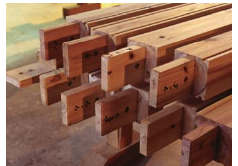
伝統的な構法の「長ほぞ」に加工された柱の先端。
