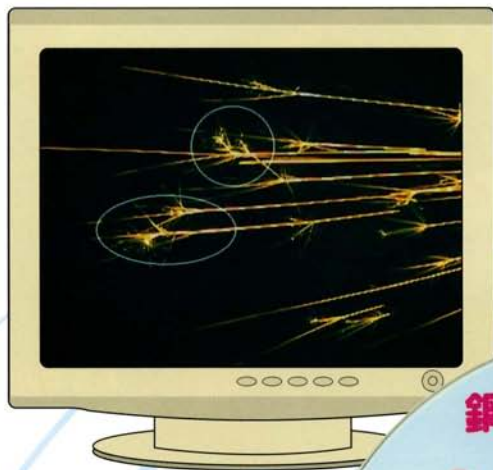
●飛びでた火花を映像化 (S50Cの例)
